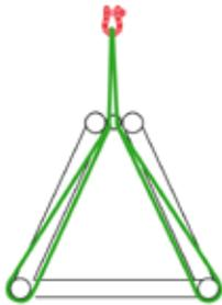
Viergurt-Traverse, trapezförmiger Querschnitt
